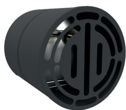
DraftBox light Nebenluftvorrichtung nach DIN 4795 für Einzelfeuerstätten mit raumluftabhängiger Zulufführung
